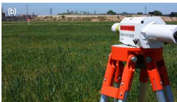
Figura 2. Imágenes de la estación meteorológica (a) y el escintilómetro (b) sobre el cultivo.
